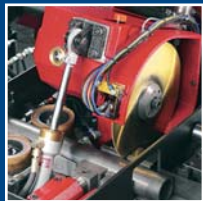
Sägeblatt kommt von oben kürzeste Rüstzeiten und optimale Kraftverteilung
